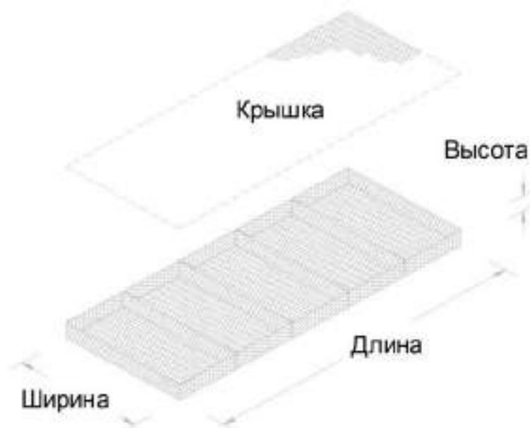
Рисунок Б.3 Контейнер матрасно-тюфячного габиона.
